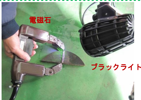
探傷例：極間式(蛍光磁粉)
