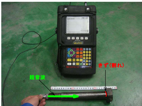
ボルト探傷状況
