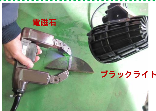
探傷例：極間式(蛍光磁粉)
