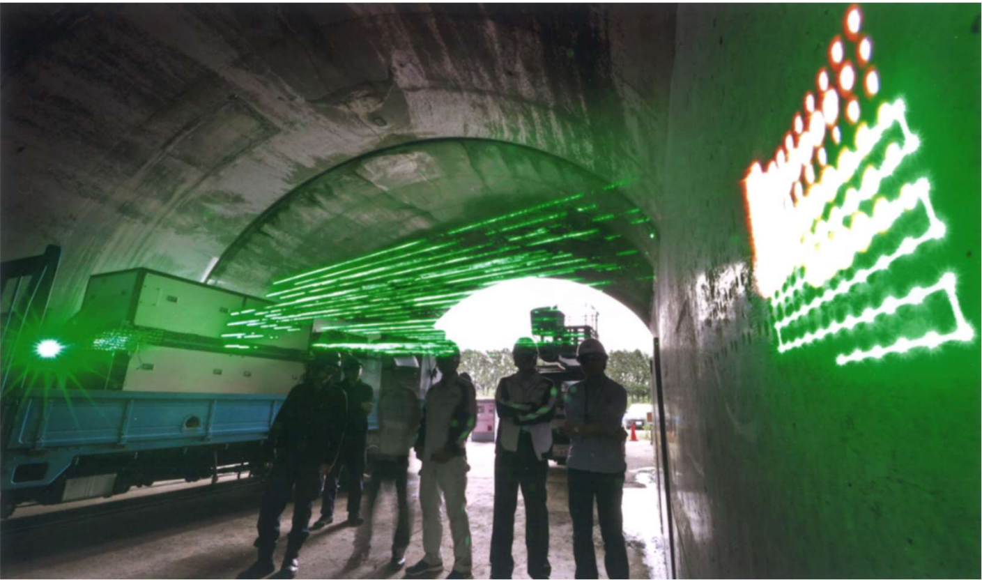
レーザー打音システムの実験風景 (2017/7/1 日本経済新聞記事の写真。掲載許可済) ー 実験場所: 施工技術総合研究所(静岡県富士市) 模擬トンネル ー
