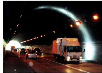
走行型トンネル計測システム (MIMM)
