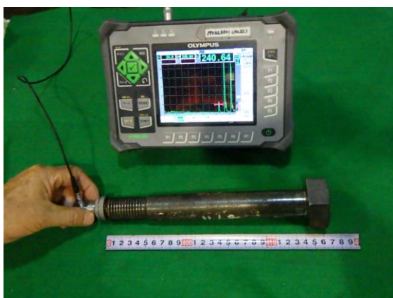
ボルト探傷状況
