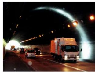
走行型トンネル計測システム (MIMM 計測検査製)
