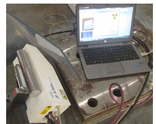
鋼橋溶接部の測定
