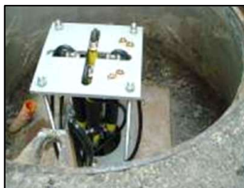
掘削時の地盤の沈下や掘削地と周辺の水の 浮き上がりを監視
