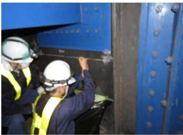
▶含有量分析試験・溶出量分析試験にて塗膜のPCB(鉛等有害物質)の含有量を調査が可能
