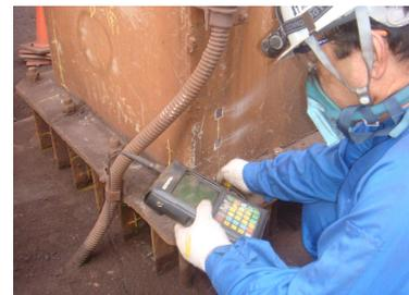
▶超音波厚さ計を用いて、板厚・減肉・腐食状況の確認が可能
