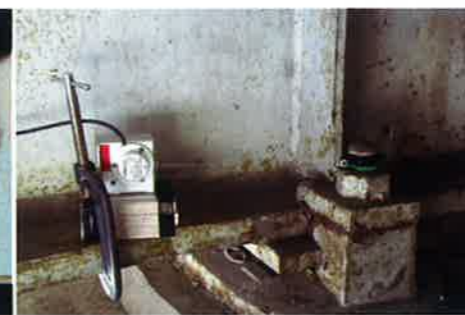
■巻き取り式変位計の設置状況
